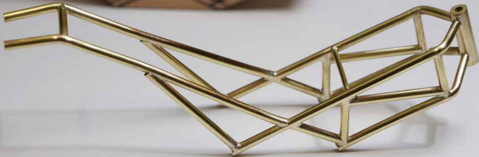
こだわりのトラスフレームを真鍮ロッドを使って、銀ろう付け細工で再現する
